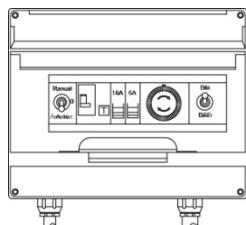
• **Панель электроконтроля фильтрующих гидромассажных лестниц** включает таймер, дифференциальный выключатель, предохранители цепей электромотора и прожекторов, переключатели режимов работы, выключатель прожекторов.
