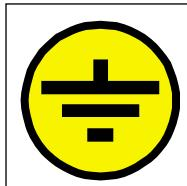
Выполните заземление фильтрующего оборудования согласно нормам вашей страны. Гибким медным проводом сечением 10 mm<sup>2</sup> подключите фильтрующее оборудование к заземлению.
