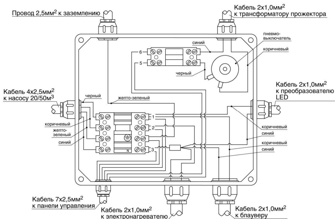
**СХЕМА ПОДКЛЮЧЕНИЯ БЛАУВЕРА (ВОЗДУШНОГО НАГНЕТАТЕЛЯ)
