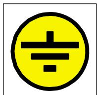
Выполните заземление фильтрующего оборудования согласно нормам вашей страны. Гибким медным проводом сечением 10  $\text{мм}^2$  подключите фильтрующее оборудование и техническую часть к заземлению.
