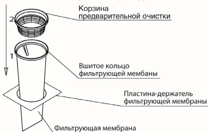
Последовательность установки фильтрующих элементов
